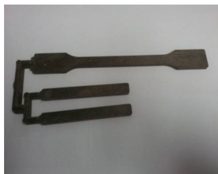
Hình 01. Máy ép phun SW-120B và mẫu thử kéo, uốn
