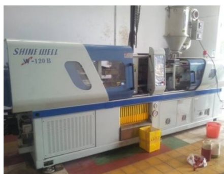
Hình 01. Máy ép phun SW-120B và mẫu thử kéo, uốn
