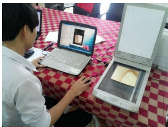
Hình 1. Sử dụng phần mềm Image J để xác định tỷ lệ co rút của ván mỏng (tính theo tỷ lệ thay đổi diện tích)
