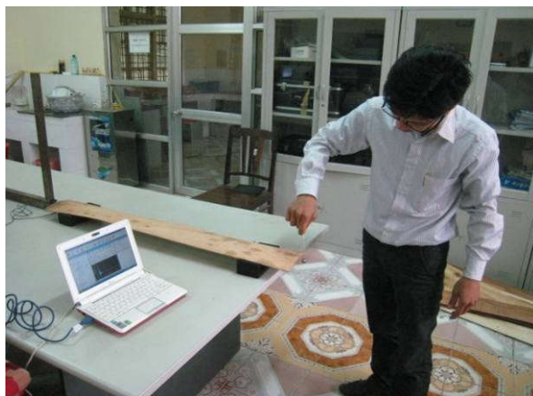
Hình 2. Thí nghiệm xác định modul đàn hồi uốn tĩnh bằng phương pháp không phá hủy mẫu (BING test)
