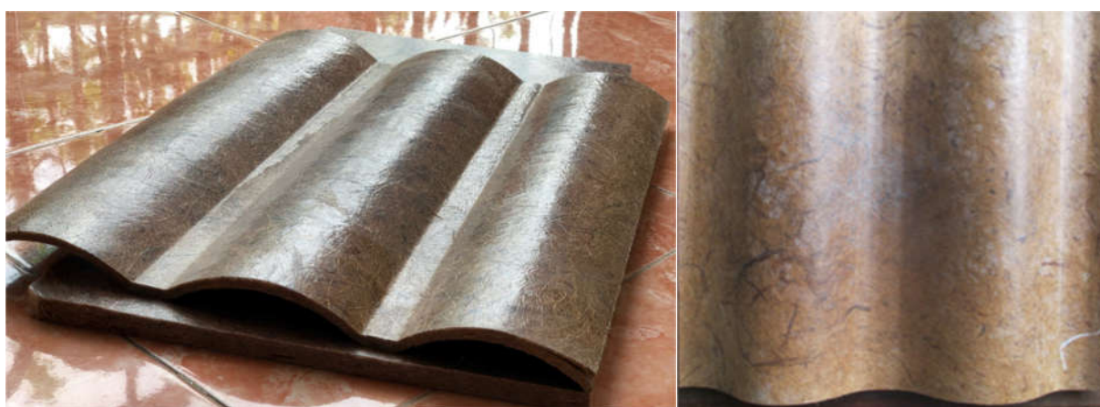
Hình 4. Sản phẩm composite xơ dừa – nhựa dạng viên ngói và sóng
