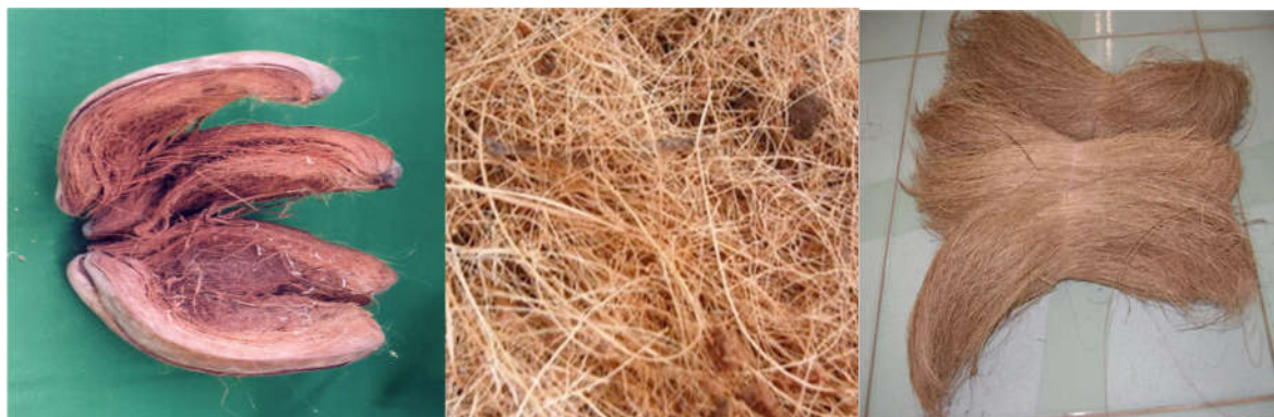
Hình 1. Vỏ dừa khô và hai hình thái xơ dừa: rối - sóng
