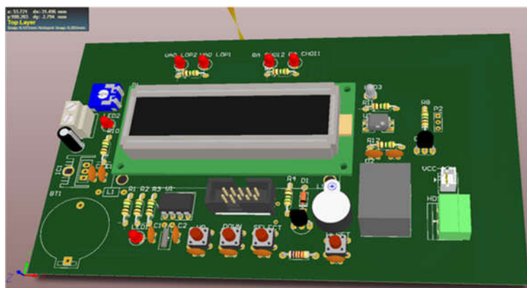
Hình 10. Sơ đồ mạch in dạng 3D của bộ điều khiển
