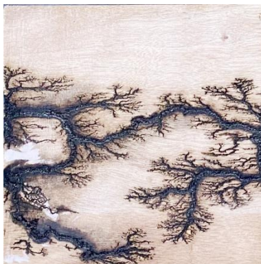
Mẫu xử lý bằng dòng 3000 V sau khi làm sạch bề mặt
