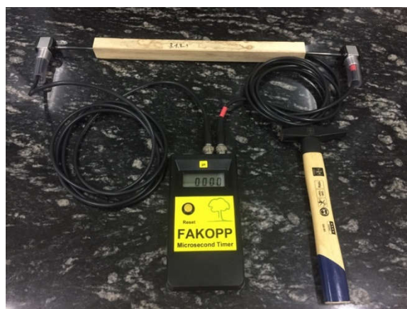
Hình 1. Chuẩn bị thí nghiệm đo thời gian truyền sóng ứng suất
