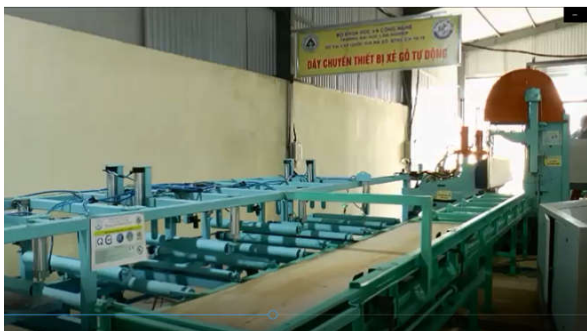
a) Ván được HT rulo đầu vào đưa tới hệ thống rọc rìa
