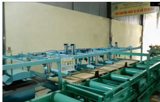
b) Ván được băng tải xích tạo chuyển động ngang qua hệ thống cảm biến để nhận dạng rìa
