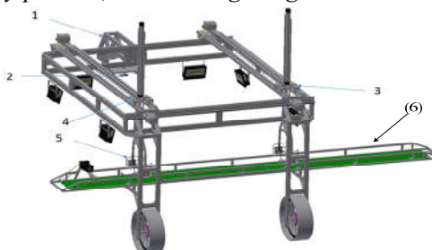
Hình 2. Cấu tạo tay máy Robot thu hoạch dứa 1-Khung công tác; 2-Camera để nhận dạng trái dứa; 3, 4- Hai tay máy hái dứa; 5-Bàn tay máy gắn dao cắt dứa.
