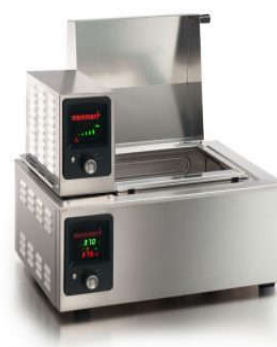
(d) Thiết bị thực hiện làm giàu \alpha -cellulose theo phương pháp kiềm lạnh (bể điều nhiệt)
