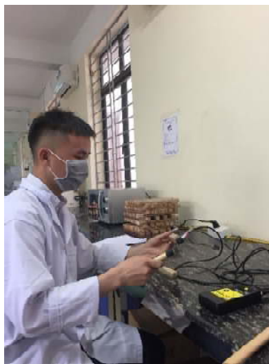
Hình 1. Quá trình đo vận tốc sóng ứng suất tại Viện Nghiên cứu và Phát triển Lâm nghiệp, Trường Đại học Nông Lâm Thái Nguyên
