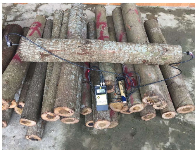
Hình 2. Đo vận tốc truyền sóng ứng suất và khối lượng riêng các khúc gỗ Keo lá tràm
