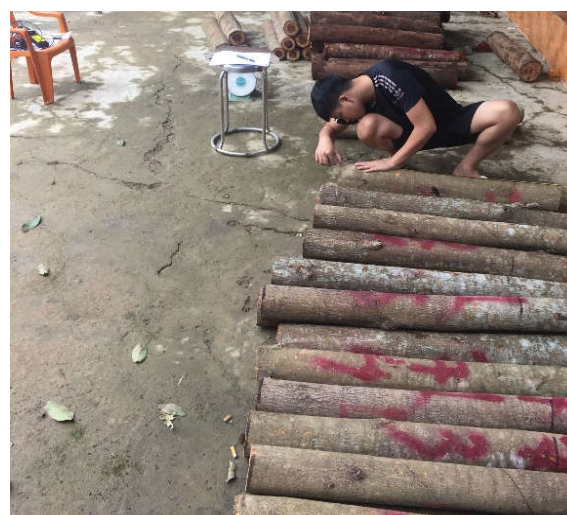
Hình 2. Đo vận tốc truyền sóng ứng suất và khối lượng riêng các khúc gỗ Keo lá tràm
