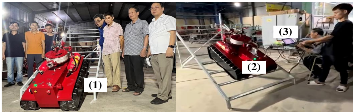
Hình 20. Thử nghiệm khả năng leo của robot với mô hình cầu thang
