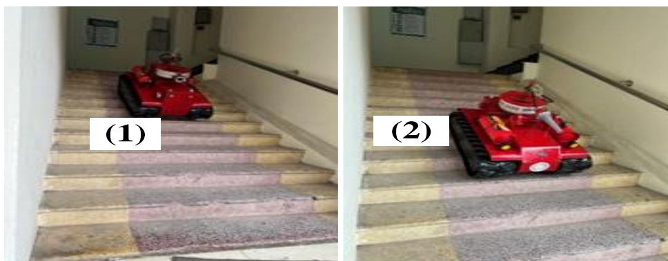
Hình 21. Thử nghiệm khả năng leo cầu thang thực tế
