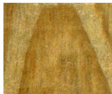
Mặt cắt tiếp tuyến
