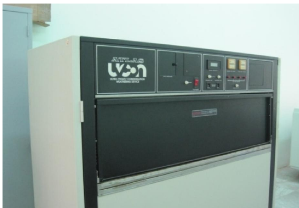
Hình 1. Thiết bị thử nghiệm thời tiết gia tốc Ultra-violet/condensation weathering device
