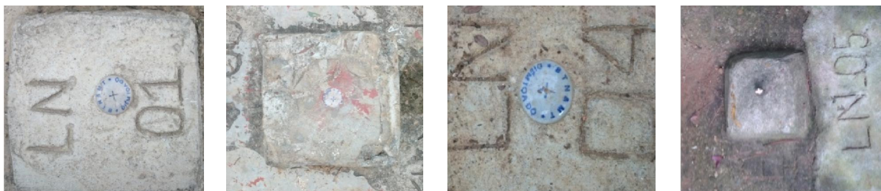
Hình 01. Hình ảnh các điểm mốc khống chế được thiết kế tại thực địa
